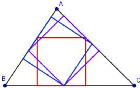
利用相似的原理，這樣的正方形可以很快得到，先在一條邊上作小正方形 DEFG，大正方形的頂點  $D_1$  必定是 AC 和射線 BE 的交點。如下圖：
